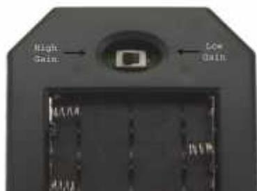
TotalAirHead には元々のプレーヤからの出力音量を二段階で設定してボリュームコントロールがしやすいようにゲインスイッチがあります。工場出荷時には"low"(プレーヤからの音量を増幅度が小さい)に設定してあります。プレーヤ側で音量を上げてヘッドホンに十分な音量が得られないときにはこのスイッチを"High"側にして試してください。電池のカバーをかねているゴムカバーを取り去ると楕円形の穴があり、Low/High を切り替えるスイッチが見えますこのスイッチを設けているのはお使いになるプレーヤ、ヘッドホンなどに最適な音量をもっとも具合良く使えるようにするためです。
