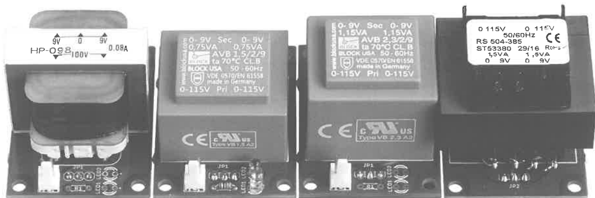
《写真A》比較したトランス(左より:豊澄HP-098, BLOCK AVB 1.5/2/9, AVB 2.3/2/9, RS 504-385)
