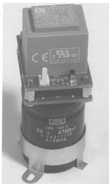
《写真B》部品交換に便利な“トランス on ケミコン”基板
