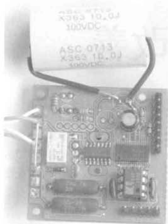
《写真B》カップリング・コンデンサをASCX363型に変更
