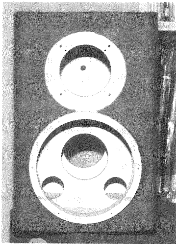
《写真 G》キャビネットの外側にフェルトを貼りつける
